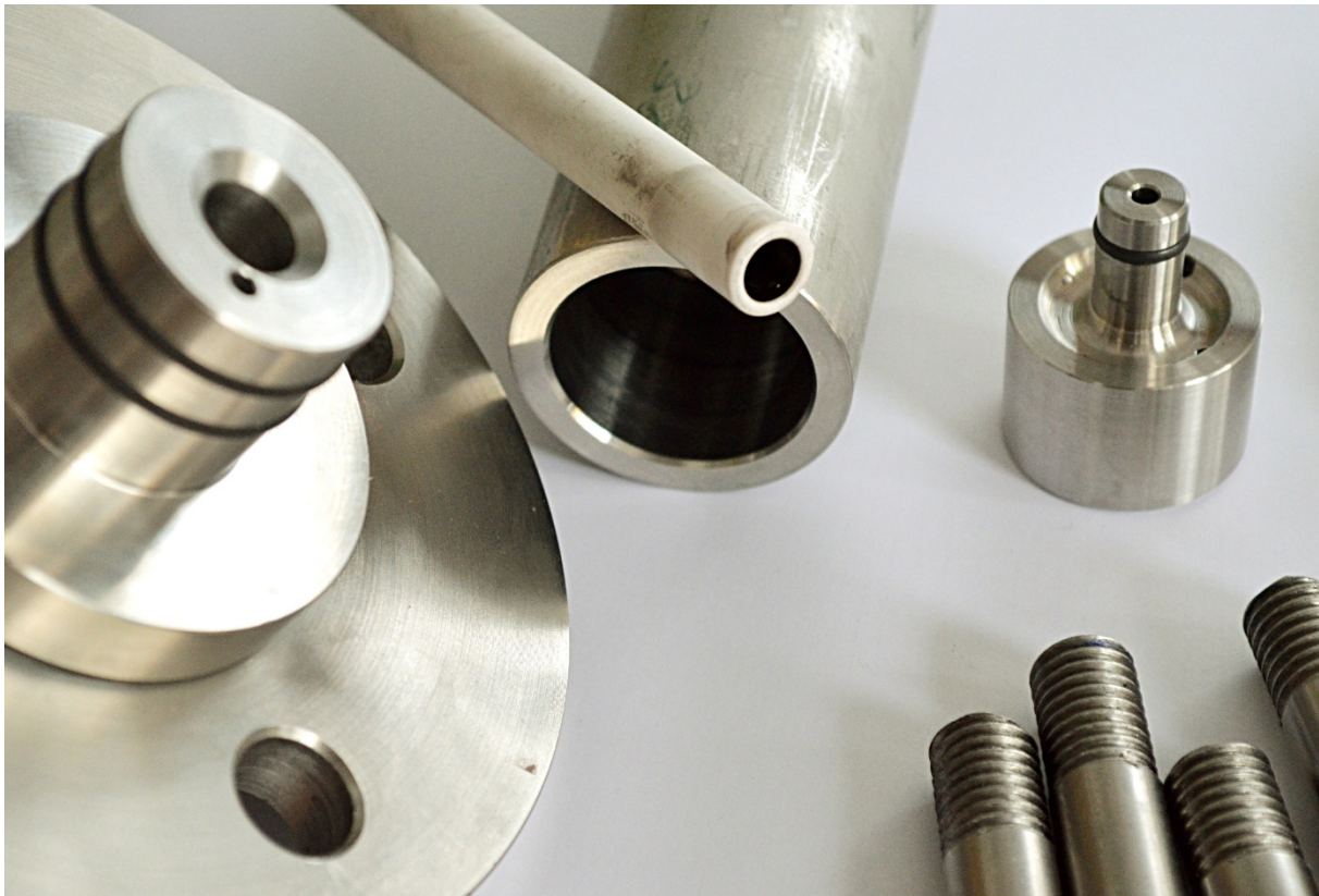
Abbildung 1: Kohlenstoff-Rohrmembran mit Hochdrucktestzelle
